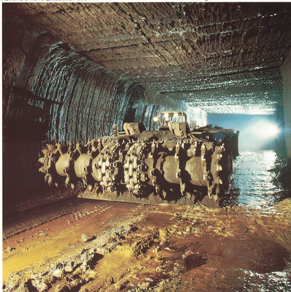
Kontinuierliche Erzabbaumaschine in der französischen Grubenabteilung der ARBED.
