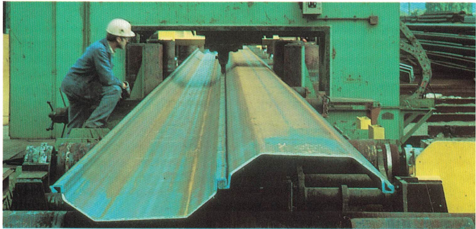
Klauenverpreßanlage für Spundwandbohlen.
