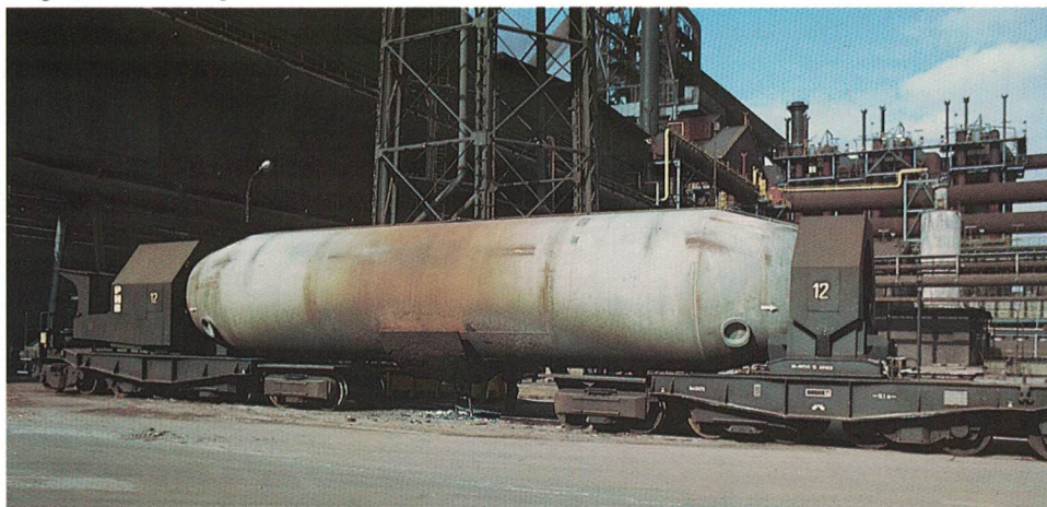
Torpedowagen zum Transport von flüssigem Roheisen.
