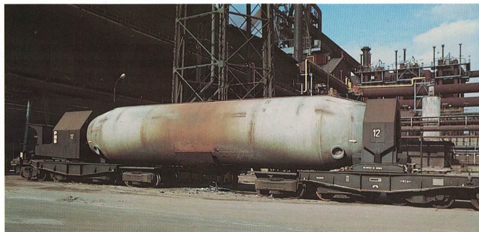
Poche-tonneau pour le transport de fonte liquide.
