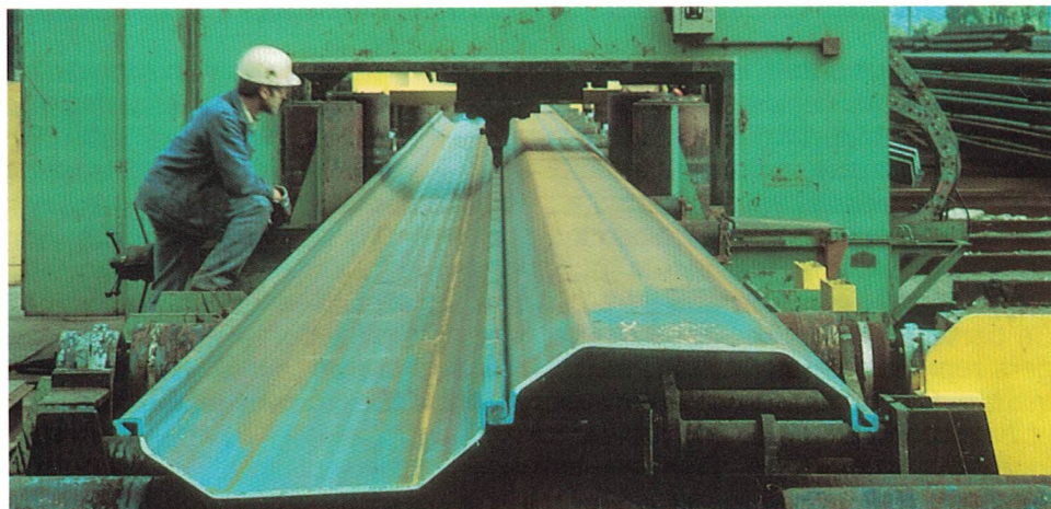
Presse automatique de palplanches.
