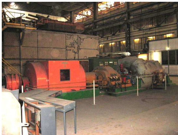
Foto 4: Turbogebléiss fir d'Wandproduktioun vum Héichuewen „B“ (Foto 2013 opgeholl)
