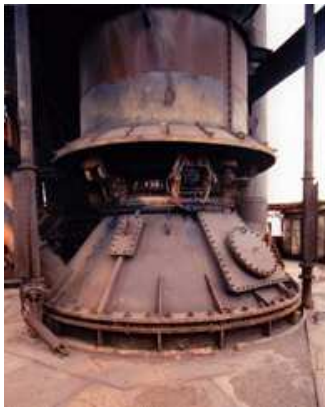
Hochofen A mit dem Glocken-Gichtverschluß von Davy McKee. Der drehbare Verteiler ist gut im oberen Teil des Bildes zu erkennen.
