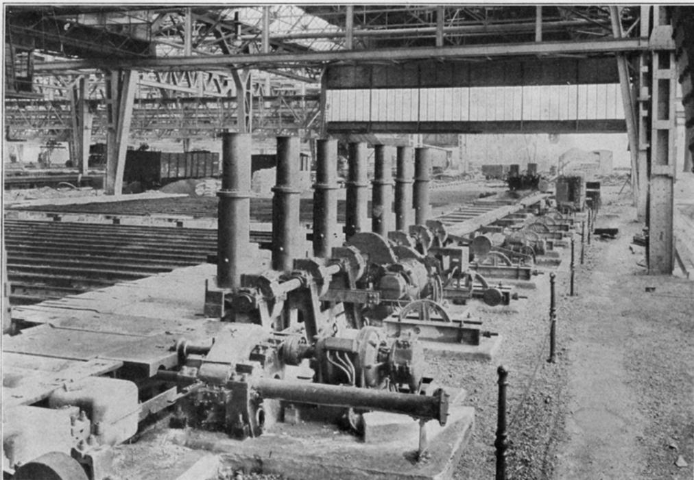
Abbildung 31. Platinenstapelvorrichtung.
