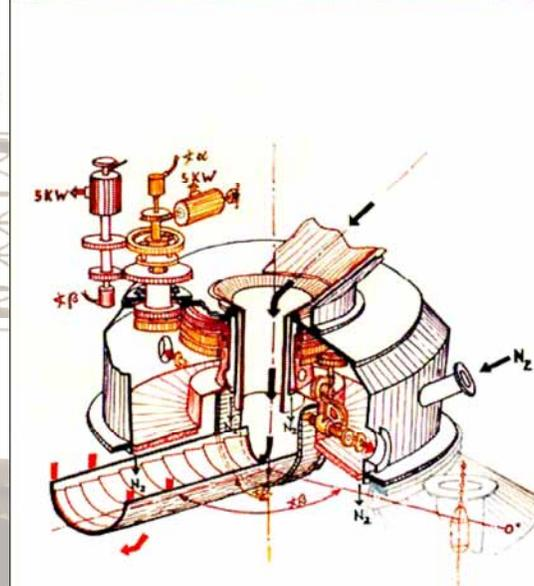
Image: Principe de fonctionnement de la goulotte de distribution du gueulard sans cloches.
