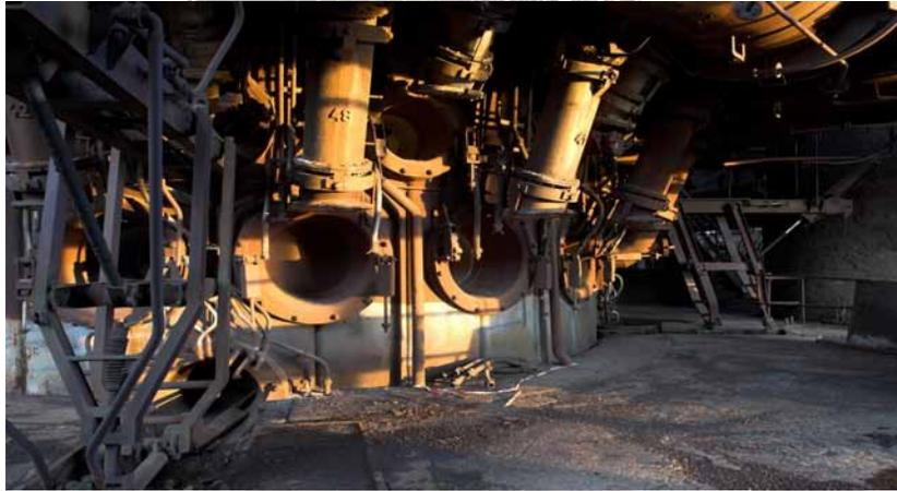
Image: Emplacement des portes-vent sur un HF "A"
