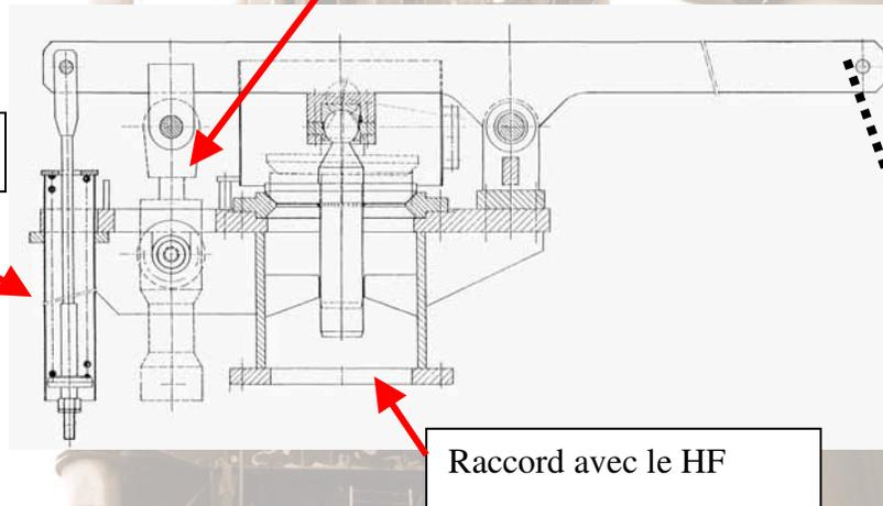
Image: schéma de principe d'une vanne de sécurité ou d'explosion.
