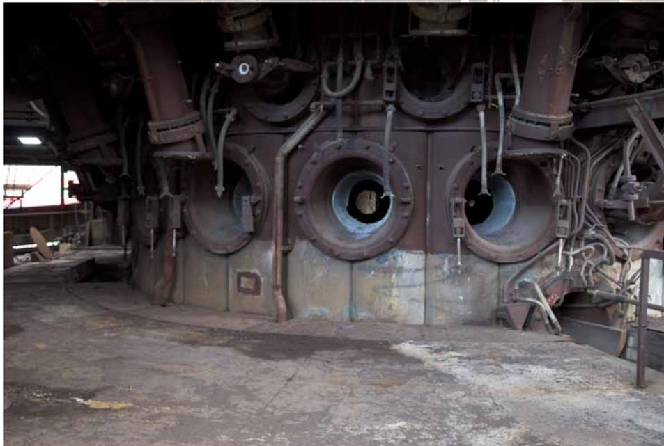
Image: Emplacement des portes-vent sur un HF "A"
