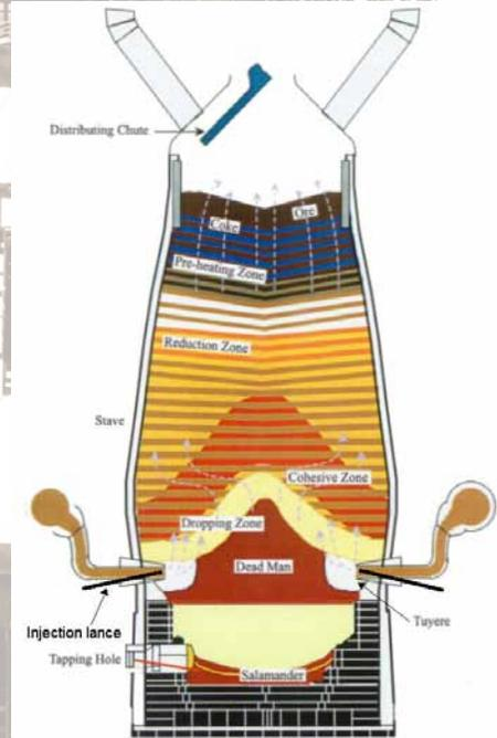
Image. Principe des porte-vent sur un HF.
