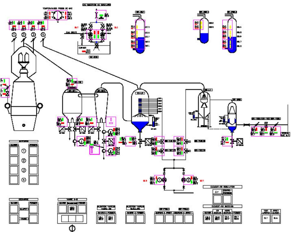
Image: Synoptique récupération et épuration de gaz.
