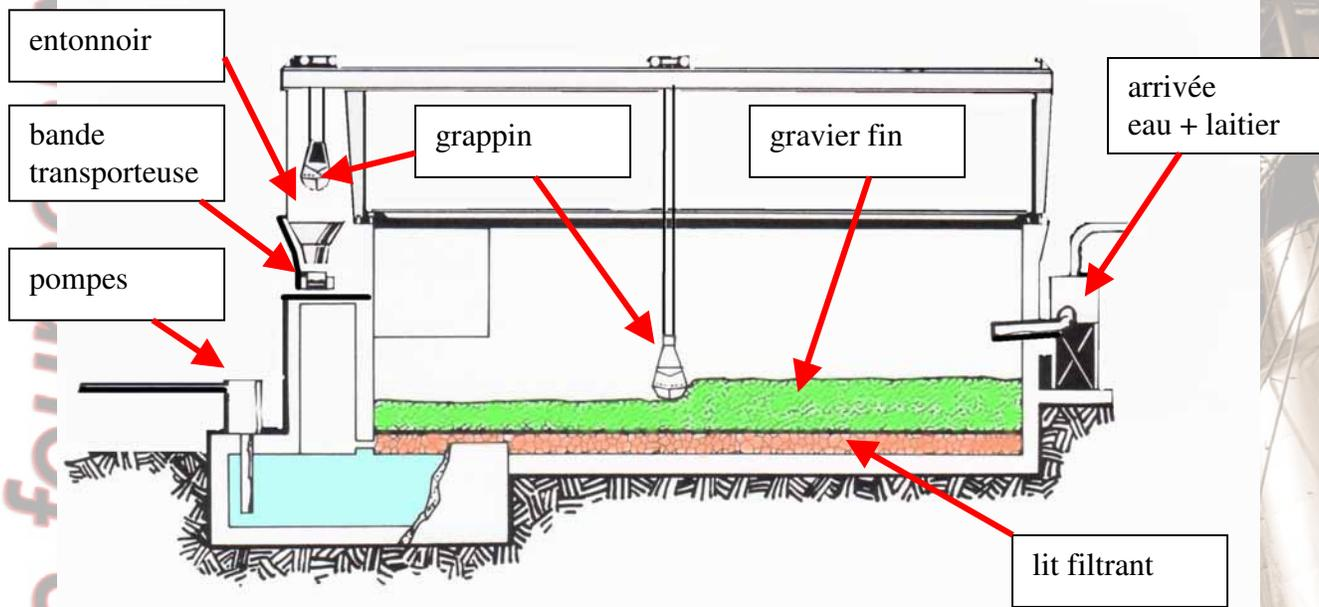
Image: Principe du bac de granulation.
