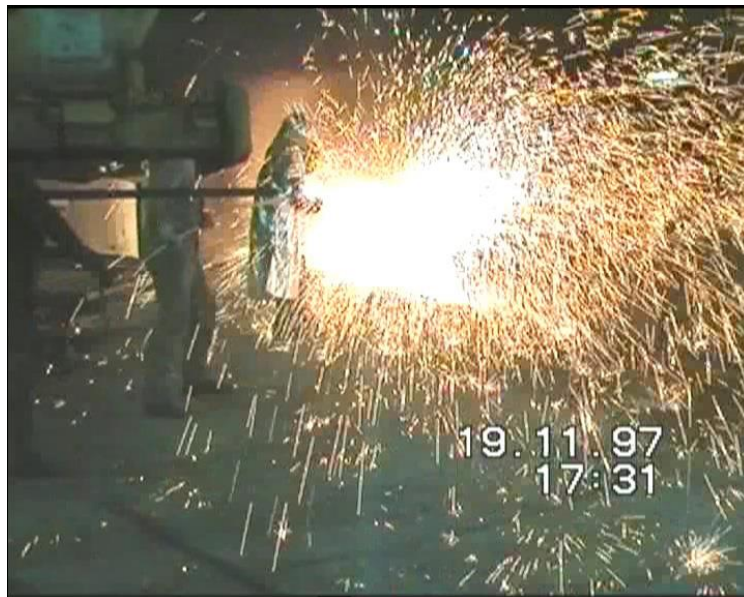
Image: Ouverture du trou de coulée par oxycoupage.
