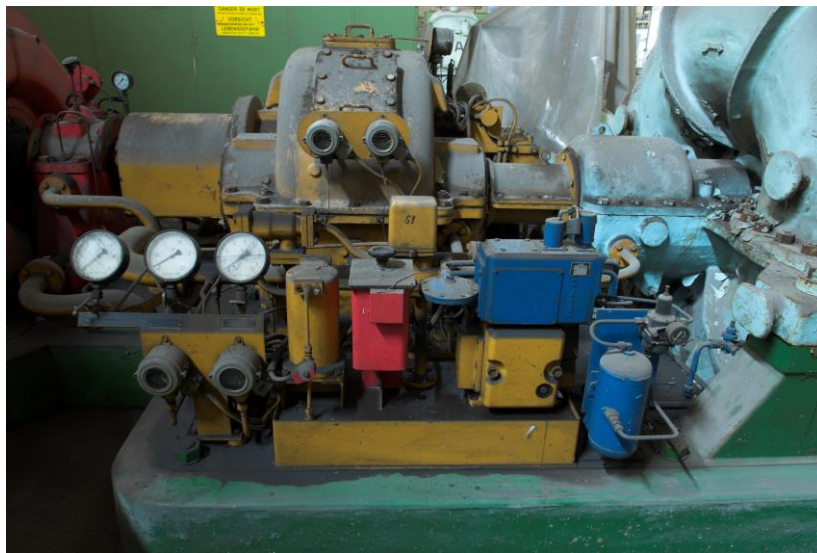
Image: Accouplement soufflante avec graissage des palliers
