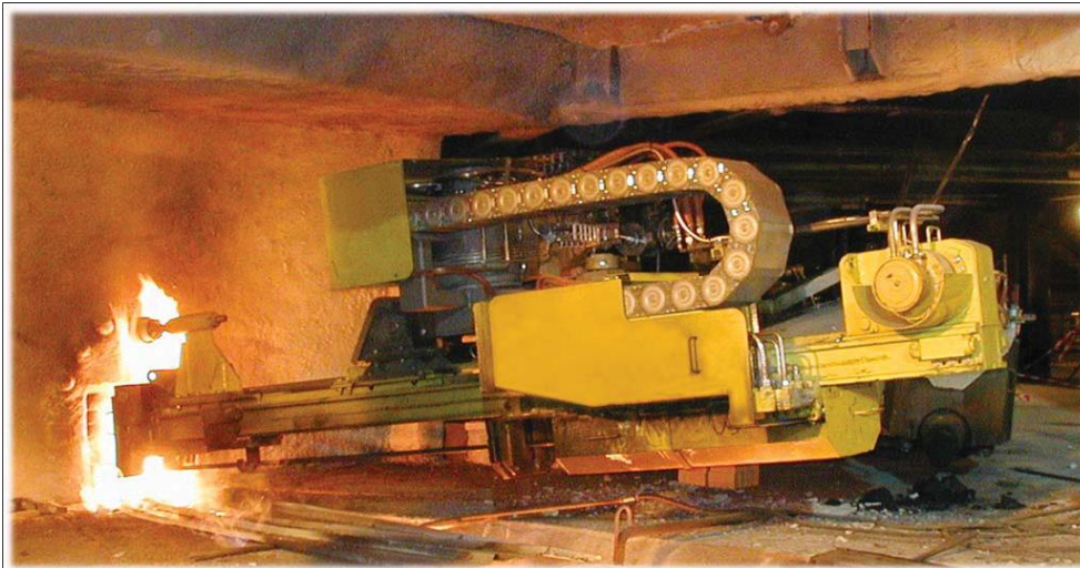
Image: Une foreuse hydraulique asservie dernière génération.
