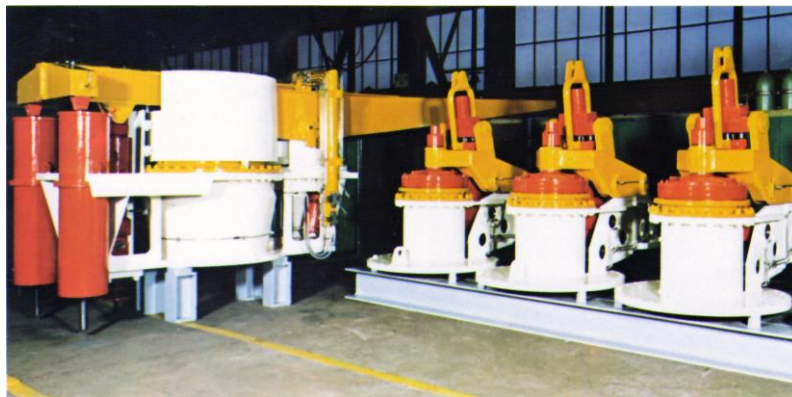
Image: vannes de sécurité ou d’explosion en atelier de fabrication.
